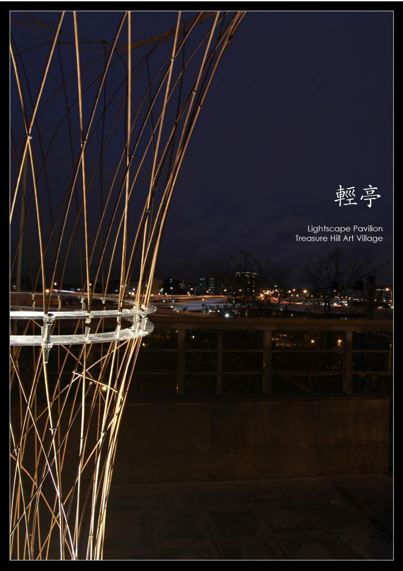
新注入的創作家與舊的村落之結合,讓國際藝術村一寶藏嚴,成為一個獨特的藝術空間。與寶藏嚴的精神相呼應,新舊共存,讓設計更添趣點。此作品概念是在寶藏嚴的高點創造一個視覺點,融入村落並且成為景觀的一部分。設計源於古時候元宵節提的燈籠,不僅能從遠處欣賞,參觀者更能進入燈籠的裡面,自由穿梭。以傳統燈籠的結構材料一竹子,及新的雷射切割技術將壓克力穿孔,將細竹一根根的串起來形成一個竹棚,再將一個個竹棚連接成主體。結合輕形結構的設計、材料及功能,創造有趣的休憩空間,開放給遊客、藝術家及村民共同使用。晚上會由竹棚中心部位打光,利用細竹製造柔和的燈光,令原本開闢的屋頂變得細緻。
